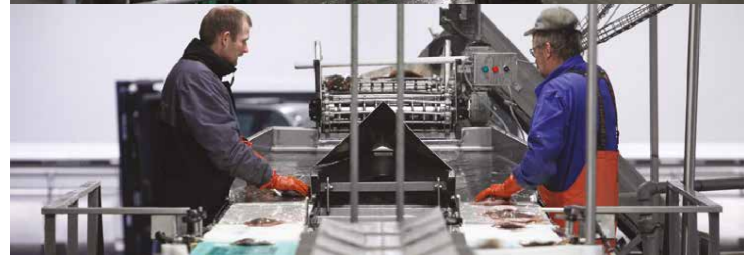
Fiskene vejes og sorteres automatisk ud i 10 størrelser på graderen og mærkes med info om sporbarhed og nettovægt, inden de går på auktion.
